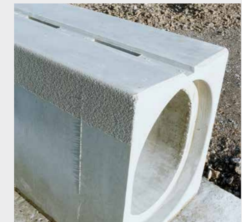
Eine aufgeraute Oberfläche im oberen Bereich der Schlitzrinnen ermöglicht eine kraftschlüssige Verbindung zwischen Rinne und Asphaltfläche.
